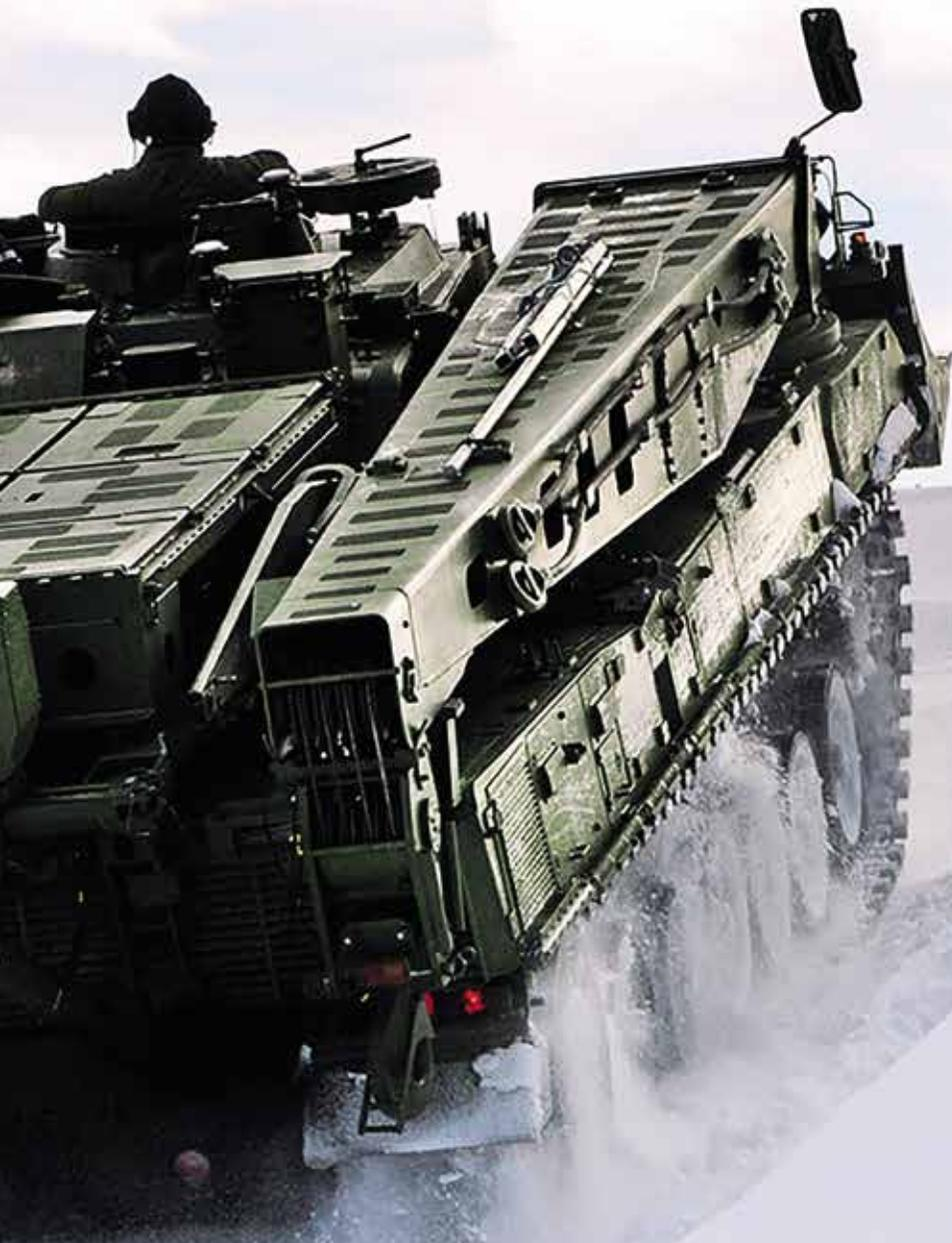
Als Berpepanzer bietet der WiSENT 2 einen 32t Kranarm sowie ein ausgereiftes Combat Recovery System (CRS), das die Bergung anderer Fahrzeuge unter vollem Schutz ermöglicht.
