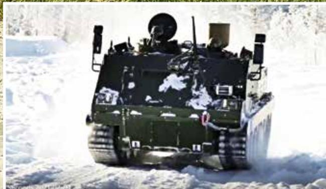
Der ACSV G5 läuft auf einem Komposit-Gummi-Kettensystem, das Vibrationen und Geräusche sowohl innerhalb als auch außerhalb des Fahrzeugs drastisch reduziert. Damit verringert die „Gummikette“ die Belastung der Ausrüstung sowie der Soldaten im Fahrzeug. Die Kettenaufstandslänge und die Breite der Kette sorgen für einen sehr niedrigen Bodendruck und garantieren eine hervorragende Mobilität auf allen Untergründen, speziell auch auf Schnee, weichem Sand oder morastigen Böden.
